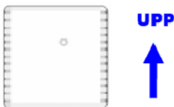
Fig. 2. Montageriktning för TBOX för inomhusbruk.
